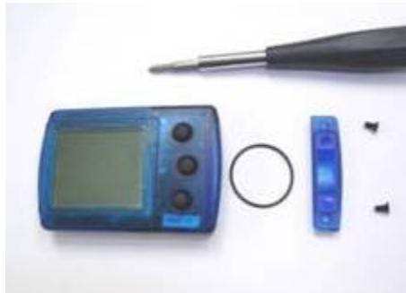
Entferne die beiden Schrauben, welche den Batteriedeckel sichern mit Hilfe eines Phillips Schraubendrehers.
