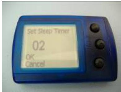
Erhöhe oder verringere die Anzahl der Stunden mit den hoch/runter Tasten.
