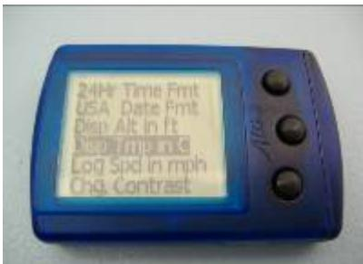
Durch drücken der mittleren Taste wird die auswahl geändert hier C (Anzeige in Celsius).
