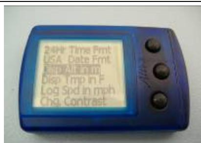
Durch drücken der mittleren Taste wird die auswahl geändert hier m (Anzeige in Meter).
