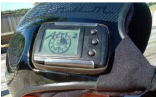
Der Helmclip ist für Aussparungen wie gezeigt gefertigt. Wenn der Clip an einem Helm ohne Aussparung montiert wird, empfehlen wir die Sicherung gegen rausrutschen des Neptune 2 mittels eines Packgummis rund um den Clip.
