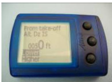
Drücke die mittlere Taste um den tausender Wert einzustellen, nutze hierfür die obere und untere Taste. Drücke kurz auf die mittlere Taste und verfahre genauso um die hunderter, zehner und einer Werte zu ändern.
