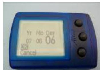
Erhöhe oder verringe den Wert und bestätige mit der mittleren Taste das eingestellte Datum wird gespeichert. Zweimaliges kurzes drücken der mittleren Taste bricht die Einstellung des Datums ab.
