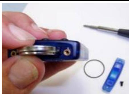
Führe eine Duracell DL2450 (oder baugleich) Batterie ein.
