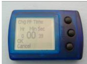
Ändere die entsprechenden Wert emit den hoch/runter Tasten und bestätige Deine Eingabe mit der mittleren Taste. Wähle OK und bestätige mit der mittleren Taste um Deine Änderungen zu speichern.
