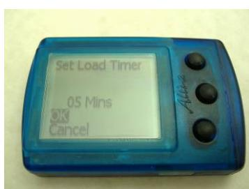
Mit kurzen Druck auf die mittlere Taste wird die eingestellte Zeit gespeichert. Wenn du auf Cancel rollst und mit der mittleren Taste bestätigst kannst Du die Einstellung abbrechen.
