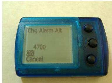
Drücke die mittlere Taste bis OK hervorgehoben wird und drücke nochmals die mittlere Taste zum speichern der Höhe.
