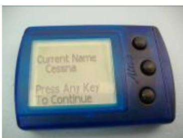
Der momentan eingestellte Flugzeugtyp wird die angezeigt. Um einen anderen Flugzeugtyp zu wählen drücke eine beliebige Taste.
