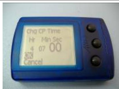
Benutze die hoch/runter Tasten um den gewünschten Wert zu ändern und bestätige mit der mittleren Taste. Wähle OK und drücke die mittlere Taste um die Einstellungen zu speichern.
