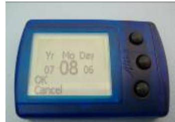
Erhöhe oder verringe den Wert und bestätige mit der mittleren Taste den richtigen Wert, die Anzeige wechselt zur Tageseinstellung.
