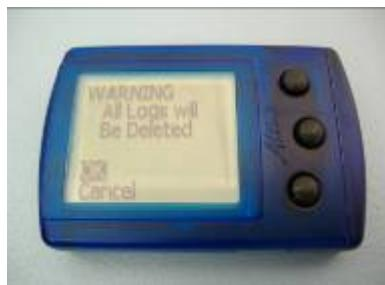
Um das Löschen des Sprungbuchs zu bestätigen, wähle OK und bestätige mit der mittleren Taste.
