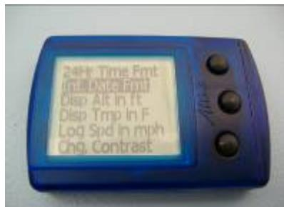
Durch drücken der mittleren Taste wird die Auswahl geändert hier Int. Date Fmt.
