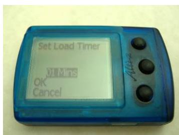
Die Minuten werden hervorgehoben, Wert einstellen und mit der mittleren Taste bestätigen.
