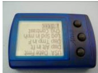
Die Anzeige ist nun gedreht zur korrekten Anzeige an der rechten Hand.
