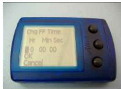
Drücke die mittlere Taste und wähle die Stunden, Minuten oder Sekunden.
