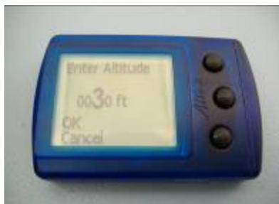
Mit der mittleren Taste das zu ändernde Feld auswählen und mit den Hoch und Runter Tasten den gewünschten Wert einstellen. Mit der mittleren Taste den nächsten zu ändernden Wert auswählen.
