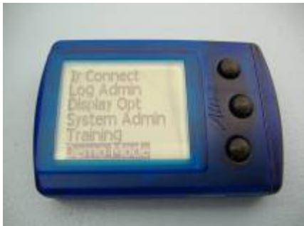
Im Demo Modus kannst Du Dir die mit den Alarm Gruppen verbundenen Alarmtöne anhören und die entsprechenden Bischirmanzeigen ansehen welche normalerweise während des Sprungs angezeigt werden.
