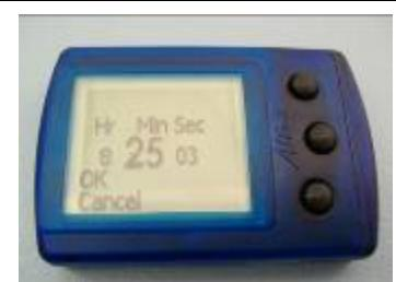
Erhöhe oder verringe die Minuten Anzeige und bestätige den richtigen Wert mit kurzem Druck auf die mittlere Taste. Die Anzeige wechselt zur Sekunden Einstellung.
