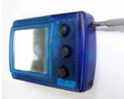
Schraube den Batteriedeckel mit den beiden Schrauben wieder am Gerät fest. Die Schrauben bitte vorsichtig anziehen, ein zu festes Anziehen lässt den Batteriedeckel brechen und das Gerät ist nicht mehr Wasserdicht.
