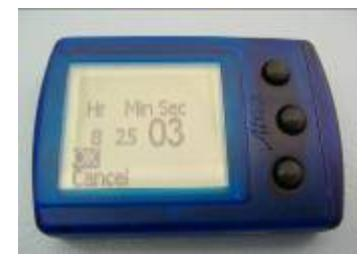
Erhöhe oder verringe die Sekunden Anzeige und bestätige den richtigen Wert mit kurzem Druck auf die mittlere Taste, die eingestellte Zeit wird gespeichert. Zweimaliges kurzes drücken der mittleren Taste bricht die Einstellung der Zeit ab.
