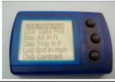
Durch drücken der mittleren Taste wird die auswahl geändert hier 12 Hr Time Fmt.
